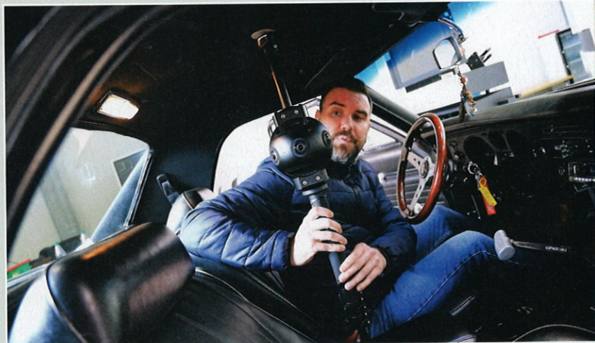
In Sekundenschnelle und ohne Werkzeug wird das Spezialkamerasystem zur Erstellung des 360-Grad-Innenraumpanoramas positioniert.
