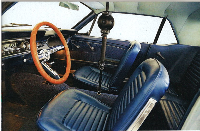
Das Spezialkamarasystem mit sechs Fischaugen-Linsen liefert ein lückenloses und zoombares Innenraumpanorama.
