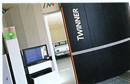
Das Licht im Twinner® Space entspricht ungefähr 20 % der Helligkeit direkter Sonneneinstrahlung.
