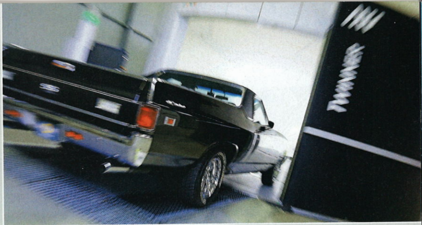
Bereits bei der Einfahrt wird der Unterboden in 5.000 Zeilen hochauflösend gescannt.
